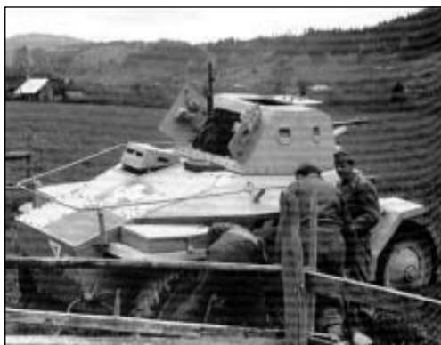
CSABA (39 MM) TÍPUSÚ FELDERÍTŐ PÁNCÉLGÉPKOCSI. A TORONY NYITOTT HÁTSÓ AJTÓJÁBAN JÓL LÁTSZIK A HÁTRAFELE TÜZELŐ GÖLYÖSZÓRÓ
