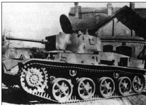
TOLDI II MAGYAR KÖNNYŰHARCKOCSI 40 MM-ES LÖVEGGEL, AMELY — BÁR ELŐRELÉPÉST JELENTETT A TOLDI I 20 MM-ES LÖVEGÉVEL SZEMBEN — ELÉGTELENNEK BIZONYULT A SZOVJET HARCKOCSIKKAL SZEMBEN
