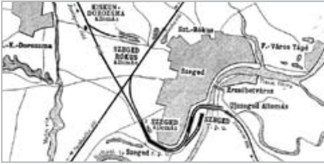
2. ÁBRA AZ 1904-BŐL SZÁRMAZÓ TÉRKÉPEN JÓL LÁTHATÓ, HOGY AZ ÚJ VASÚTÁLLOMÁS KÖZELEBB KERÜLT A BELVÁROSHOZ, DE A VONATOK IGEN KIS SUGARÚ ÍVEKEN ( R=280 MÉTER) JUTOTTAK EL A HÍDIG. AZ ÚJ SZEMÉLY-PÁLYAUDVAR VÁGÁNYZATA (EKKOR CSAK HÁROM FORGALMI VÁGÁNY VOLT) A HÍDFELJÁRÓRA, MAGAS TÖLTÉSRE ÉPÜLT. EZÉRT ÉRKEZNEK MA IS AZ ALFÖLDI VÁROSBA „EMELETRE” A VONATOK
