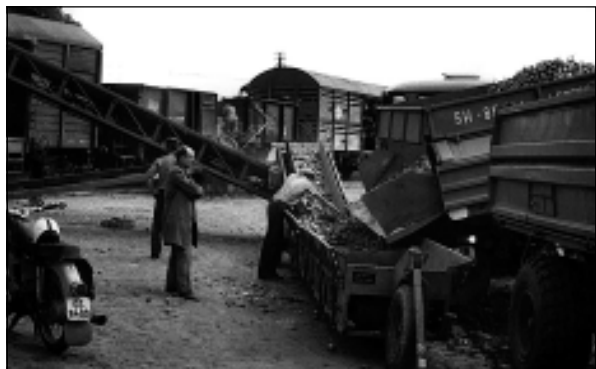
8. ábra ELEINTE ÍGY TÖRTÉNT A VASÚTÁLLOMÁSOKON A GÉPESÍTETT CUKORRÉPARAKODÁS
